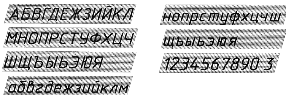
Рисунок 25 – Образец букв и цифр шрифта типа Б с наклоном
